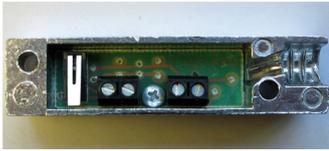
Le 462-M est similaire au 460-FR mais le raccordement se fait à l'intérieur du contact à l'aide de 4 bornes, 2 pour l'alarme et 2 pour l'autoprotection.
